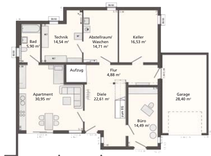
Schwörer WärmeDirektHaus Plan 765 Kellergeschoss 88,49 m² Wohnfläche, 36,12 m² Nutzfläche, Maßstab 1:200
